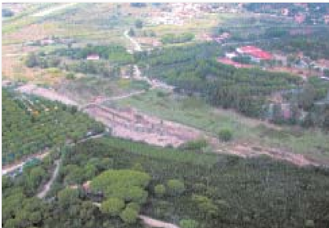
Figura 1.2.17: Ponte sul F.so Filetto a SSE est dell'abitato di Bonalaccia. La sezione di deflusso è risultata insufficiente a permettere il deflusso delle acque di piena ed ha determinato l'esondazione del fosso a monte del rilevato.
